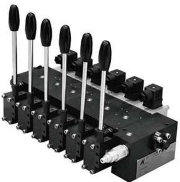
对于HLPSV型多路换向阀，每一路换向阀的负载压力经过梭阀选择后将最高的负载压力信号传至变量泵的负载敏感接口，再通过泵的变量机构的控制，使变量泵的输出压力和流量与系统相匹配，从而实现系统节能。
